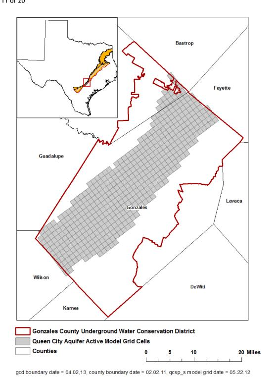
FIGURE 2: AREA OF THE GROUNDWATER AVAILABILITY MODEL FOR THE CARRIZO-WILCOX, QUEEN CITY, AND SPARTA AQUIFERS FROM WHICH THE INFORMATION FOR THE QUEEN CITY AQUIFER WAS EXTRACTED.
