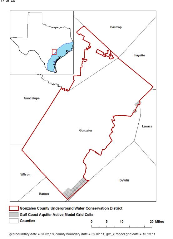
FIGURE 5: AREA OF THE GROUNDWATER AVAILABILITY MODEL FOR THE GULF COAST AQUIFER FROM WHICH THE INFORMATION FOR THE GULF COAST AQUIFER WAS EXTRACTED.
